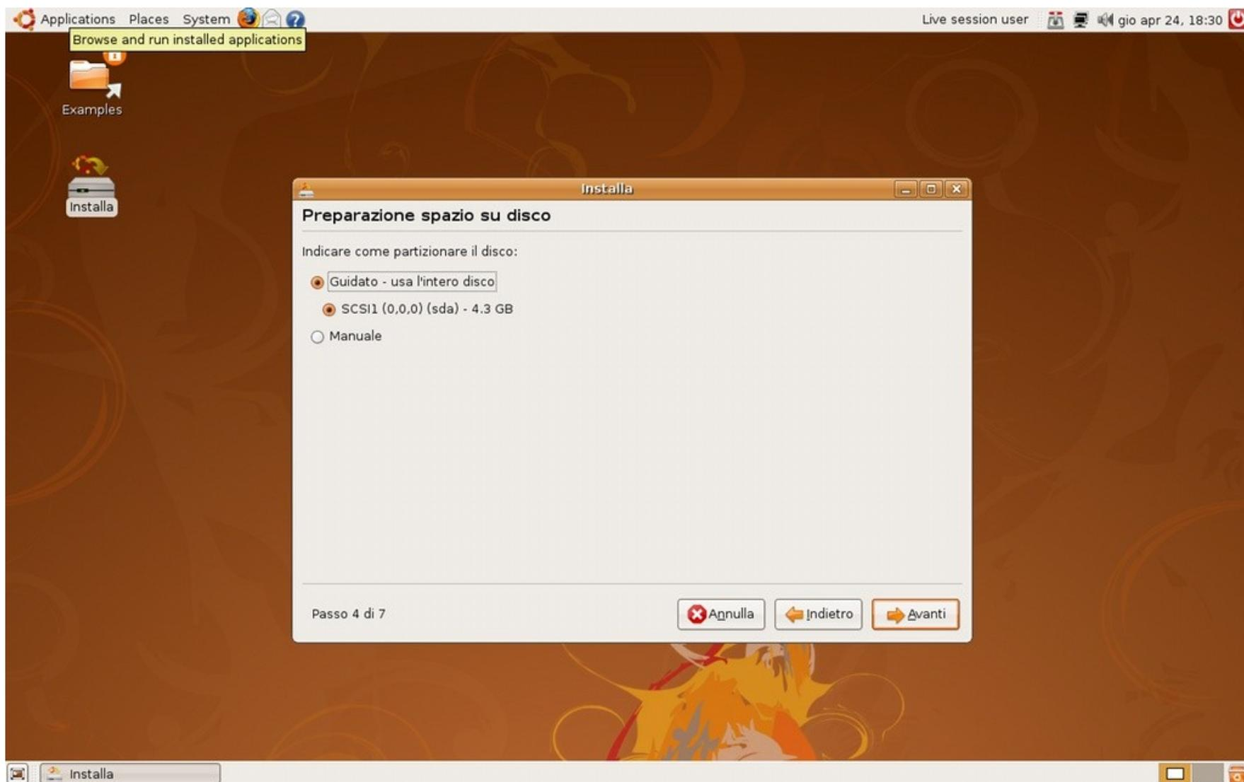
Questa è la parte più complessa di tutta l'installazione. Qui il menù può cambiare a seconda dell'hardware utilizzato. Ci possono essere più dischi e/o più sistemi operativi. Sicuramente c'è una possibilità di un partizionamento guidato che fa al caso di ognuno. Se si hanno dubbi è meglio chiedere a qualcuno esperto.
